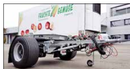
...das Dolly-System der Calag, das als Vorderachse des Anhängers genutzt wird.
