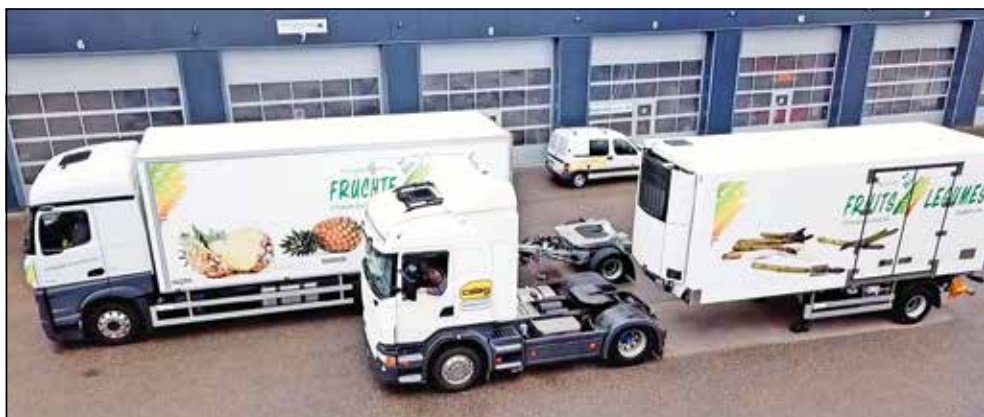
Der Kühlanhänger des hinteren Lastwagens kann auch als Auflieger genutzt werden. Der Pilotversuch hat gezeigt, dass dieses System sehr effizient und ökologisch funktioniert.
